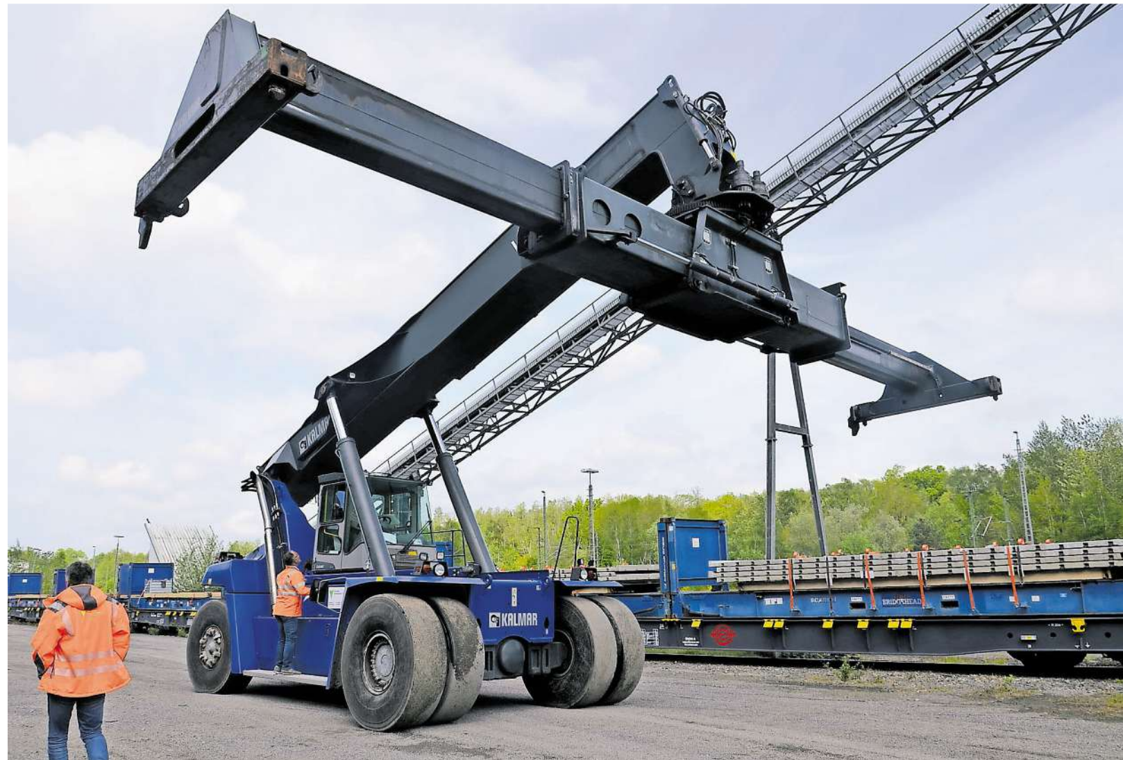
Mit einem Reachstacker werden in Stolberg Betonfertigteile für das Amazon-Parkhaus im Gewerbegebiet Avantis von der Schiene auf LKW geladen. FOTO: MÜLLER
